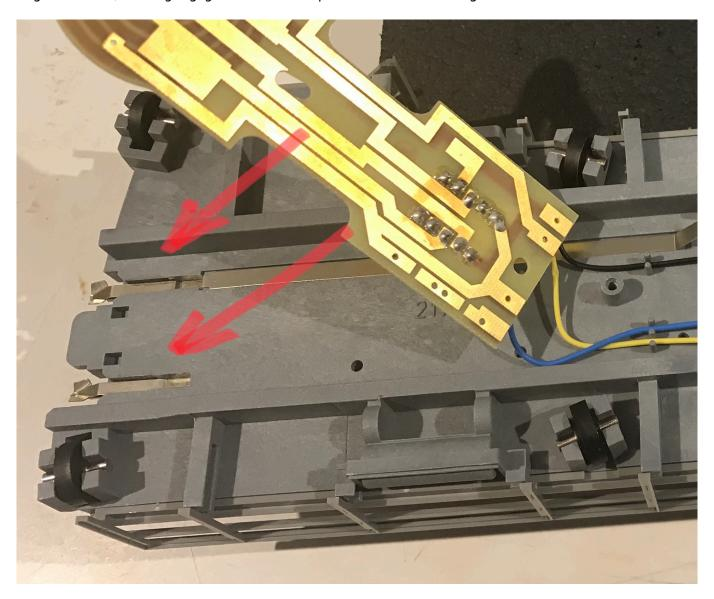
Trotz dieser elektrischen Trennung kennen 2-Leiter-Modellbahner das Problem: nach dem Drehen der Drehscheibe kann es beim Abfahren der Lok zum Kurzschluss kommen, wenn nämlich das Bühnengleis und das Abfahrgleis unterschiedlich gepolt sind. Man muss also die Bühnengleis-Stromversorgung an geeigneter Stelle umpolen.
