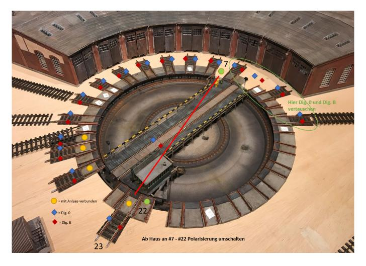
Ausgangspunkt sind die gelb markierten Gleise links, an denen die Bühne an die normale Polung vom Rest der Anlage angepasst werden muss. Hier ist das in Fahrtrichtung links Dig. 0 (blau) und rechts Dig. B (rot).
