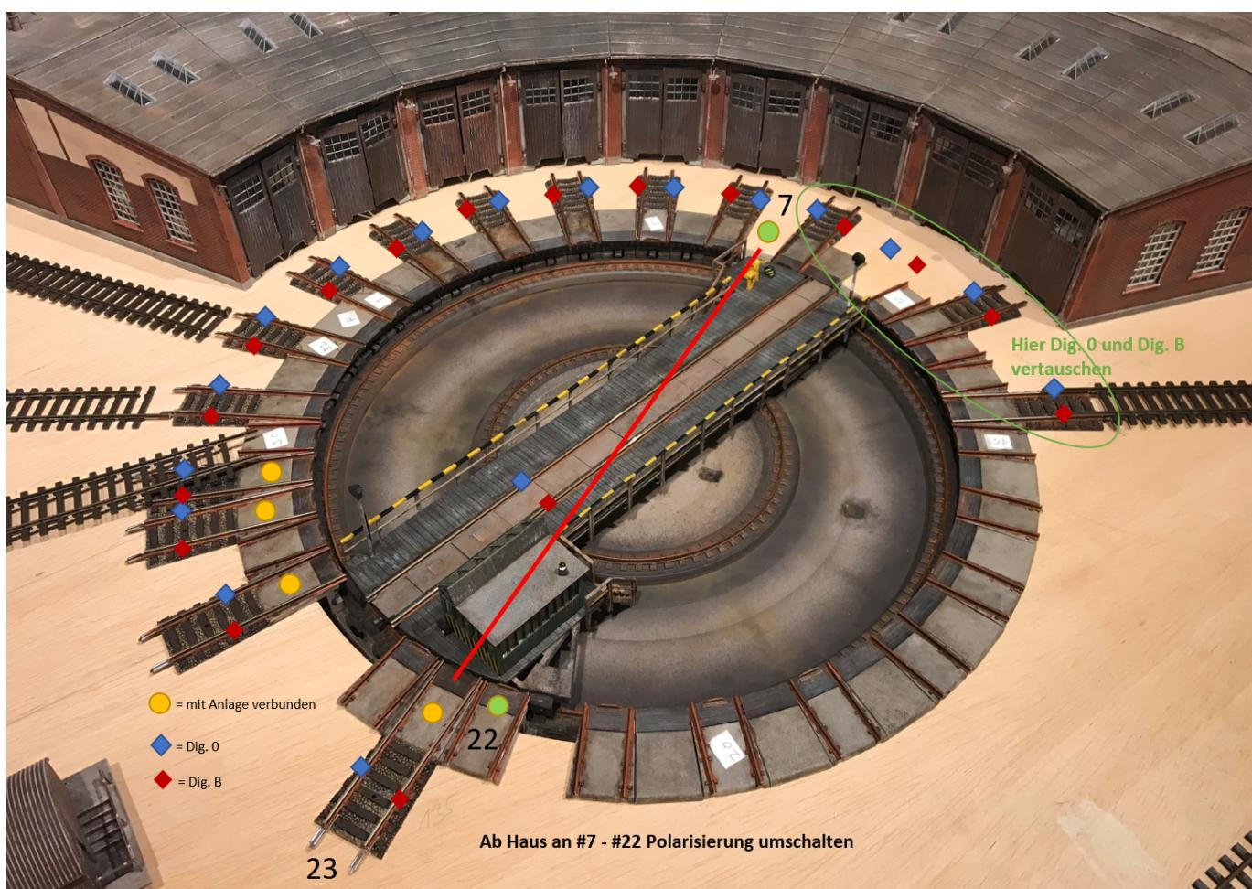
Ausgangspunkt waren die gelb markierten Gleise links, an denen die Bühne an die normale Polung vom Rest der Anlage angepasst werden muss. Bei mir ist das in Fahrtrichtung links Dig. 0 (blau) und rechts Dig. B (rot).
