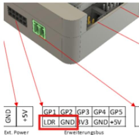
Um analoge Tasten an den externen Eingang anzuschließen, stellen Sie den Schalter auf **Sw.A** und entfernen Sie den installierten LDR. Sie können ihn einfach mit einer Pinzette herausziehen. Ein Saugnapf oder ein Stück Klebeband funktionieren auch. Der Wiedereinbau erfolgt in umgekehrter Reihenfolge: Setzen Sie den LDR in die Aussparung oben am Gehäuse ein. (Es gibt zwei Löcher, die die Beine des LDR zum Anschluss führen.)
