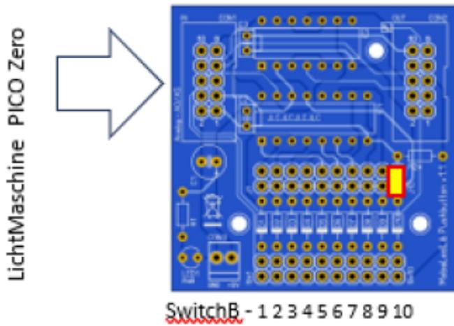
Bei Verwendung von zwei Platinen opfert die erste Platine ihren letzten Anschlusspunkt und die zweite ihren ersten. Insgesamt ergeben sich so 9 + 9 Anschlusspunkte. (Dies muss durch Jumper gekennzeichnet werden - siehe Beispiel -
