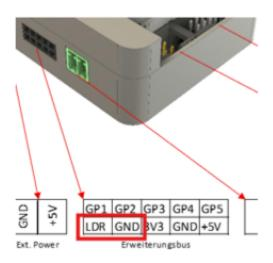
Um analoge Tasten an den externen Eingang anzuschließen, stellen Sie den Schalter auf Sw.A und entfernen Sie den installierten LDR. Sie können ihn einfach mit einer Pinzette herausziehen. Ein Saugnapf oder ein Stück Klebeband funktionieren auch.
