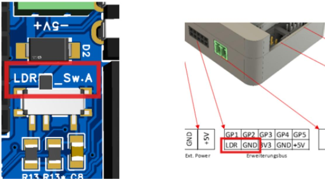
Um analoge Tasten an den externen Eingang anzuschließen, stellen Sie den Schalter auf **Sw.A** und entfernen Sie den installierten LDR. Sie können ihn einfach mit einer Pinzette herausziehen. Ein Saugnapf oder ein Stück Klebeband funktionieren auch.
