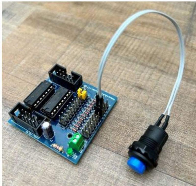
Das Foto zeigt einen Taster auf einer Zwischenplatine (der Jumper befindet sich in der vorletzten Position) und platziert auf der siebten Anschluss. (Im oben beschriebenen Beispiel ist dies SwitchB15.)
