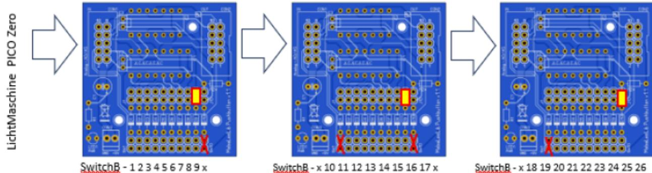
Die Pushbutton-platinen verwenden alle ein Schieberegister, das aus einem CD4017 und einem CD4011 IC besteht. Wer mehr darüber lesen möchte, findet es in der Elektor-Halbleiterzeitschrift von 1984, insbesondere in der Schaltung Nr. 99 (Schaltplan 84506) – „Schieberegister mit Schieberegistern 4017“ auf Seite 110 ☐
