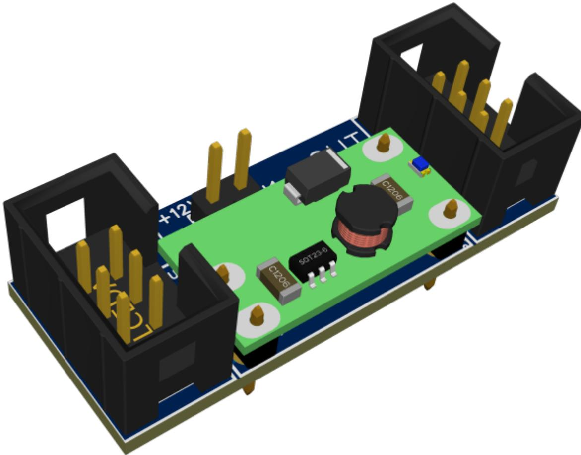
Wer kennt es nicht, man plant einen reinen 5V Aufbau für die MobaLEDLib, aber dann braucht man doch für ein Projekt 12V. Beispiele hierfür sind eine Lichterkette (LEDs in Reihenschaltung) oder den Verkehrssicherungsanhänger.
