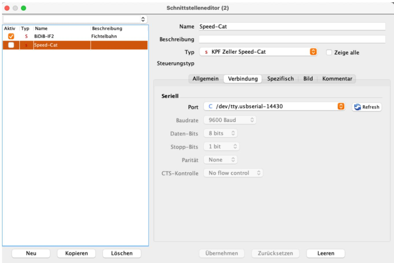
Nun legt man eine neue Schnittstelle an und wählt unter Typ den KPF Zeller Speedcat aus. Falls diese nicht im PullDown Menu angezeigt wird auf die Checkbox Zeige alle klicken.
