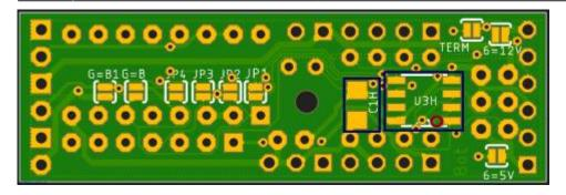
Bei der Verwendung der SMD-Version des ICs werden die Kanäle R und G vertauscht. Das heißt Out1 wird zu Out2 und Out2 wird zu Out1.
