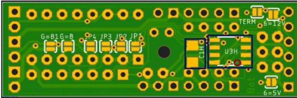
Bei der Verwendung der SMD-Version des ICs werden die Kanäle R und G vertauscht. Das heißt Out1 wird zu Out2 und Out2 wird zu Out1.
