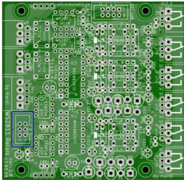
die 10 Dioden D1 - D10, sowie die Schottkydiode D11 und D12.
