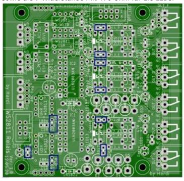
Als nächstes kommt die gelbe LED7 für die Anzeige der Spannungsversorgung und die jeweils drei grünen und roten LEDs für die Anzeige der Relaisansteuerung.
