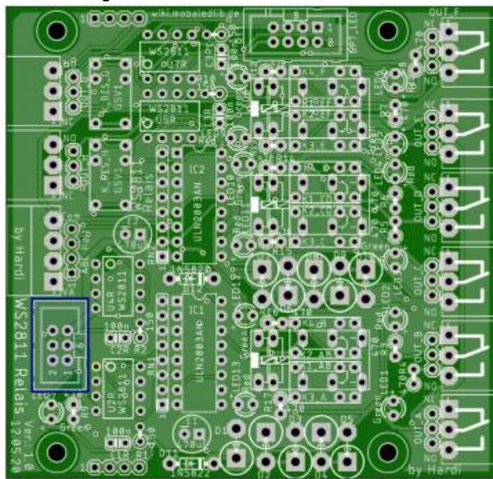
die 10 Dioden D1 - D10, sowie die Schottkydiode D11 und D12.
