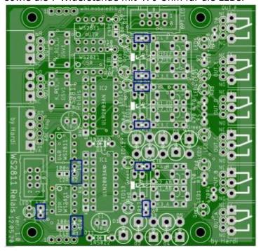
Als nächstes kommt die gelbe LED7 für die Anzeige der Spannungsversorgung und die jeweils drei grünen und roten LEDs für die Anzeige der Relaisansteuerung.
