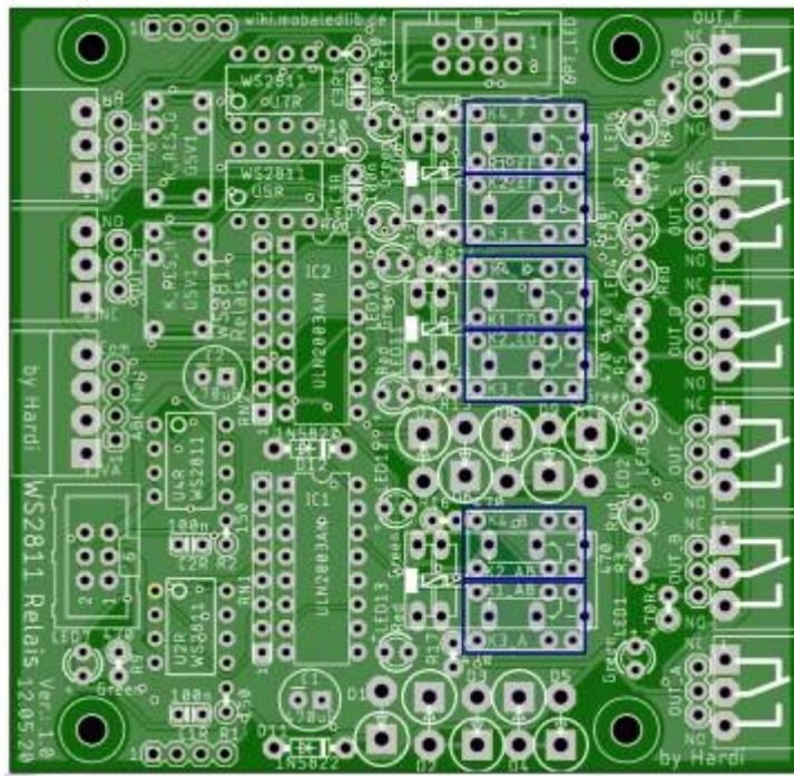
Da die beiden Elektrolytkondensator C1 & C2, mit  $470\mu\text{F}$ , die höchsten Bauteile sind, folgen diese zum Schluss auf der Oberseite.
