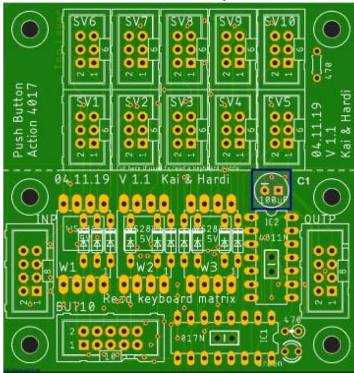
Die Bauteile **BUT10**, **R2**, **W1**, **W2** und **W3** sind nicht notwendig und die Steckplätze werden freigelassen.
