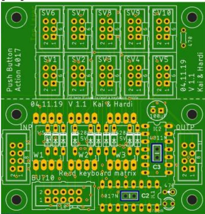
Danach folgen die beiden IC-Sockel. Der Sockel für den **IC2** sollte, sowie auch der Kerko **C3** gleich mit eingelötet werden. Dies erleichtert ein späteres erweitern auf mehr als 10 Taster.
