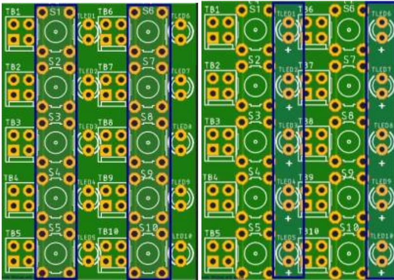
Auf der Unterseite werden im Anschluß die 4-poligen Buchsenleisten eingelötet.
