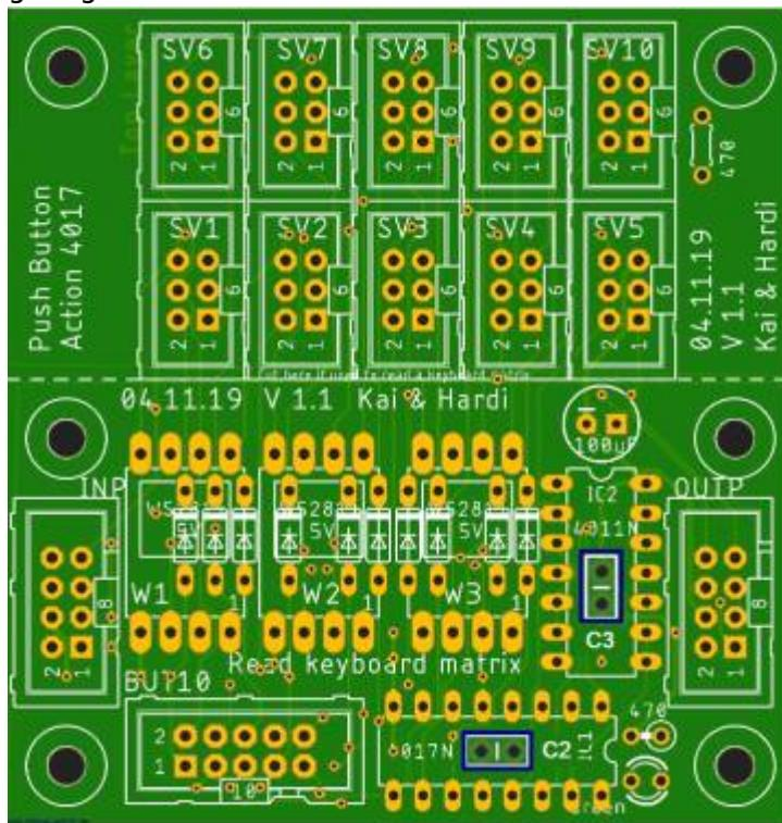
Danach folgen die beiden IC-Sockel. Der Sockel für den **IC2** sollte, sowie auch der Kerko **C3** gleich mit
