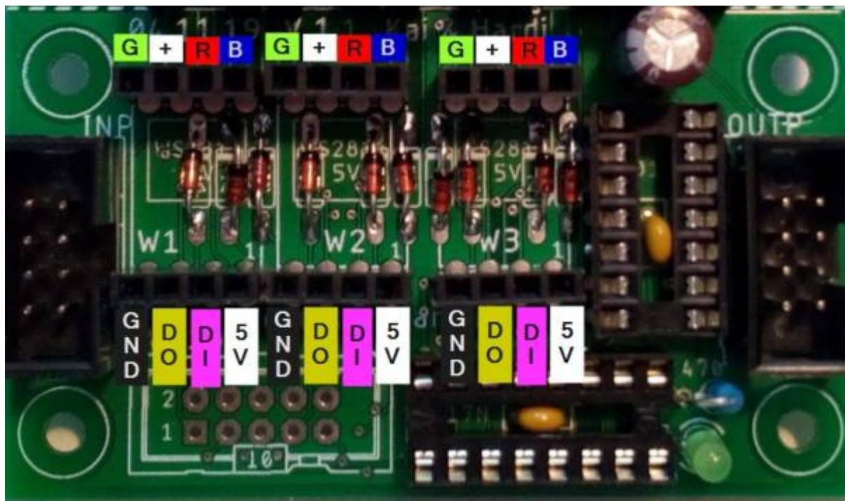
Dies kann je nach Variante des Moduls durch umdrehender Platine, durch überkreuzen der Pins oder durch eine Kombination aus Beidem erfolgen.
