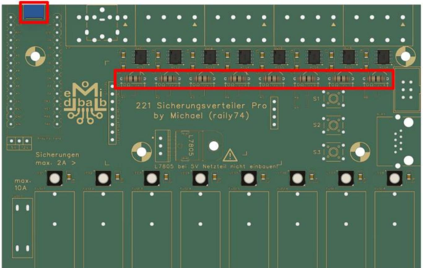
Die beiden Buchsenleisten für den Arduino, die zwei für das Display sowie die dreipolige Stiftleiste für den 5 V Jumper folgen.
