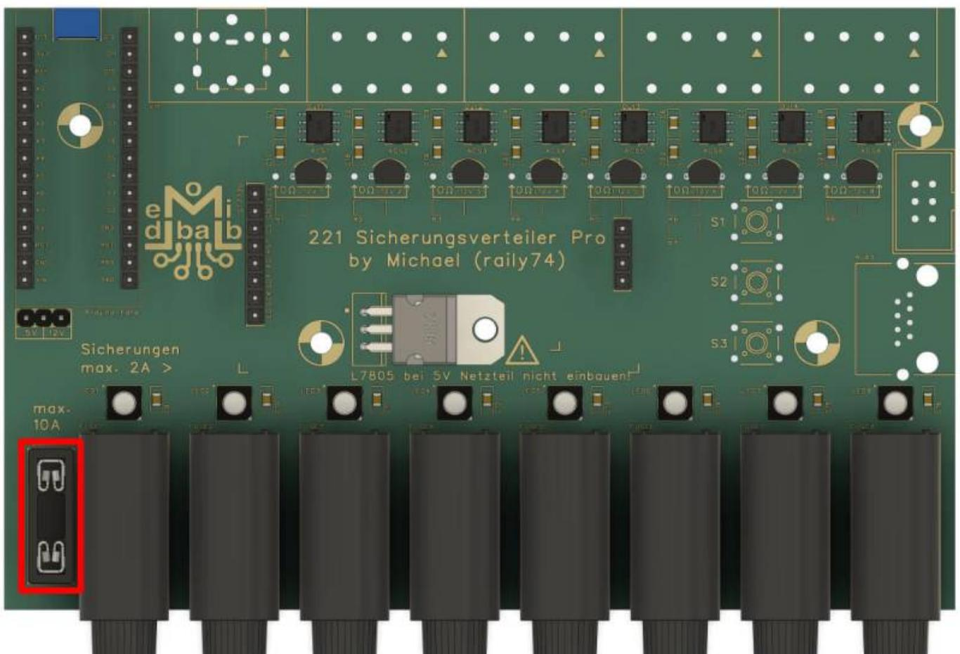
Die fünf 4-fach Klemmleisten müssen exakt ausgerichtet und gut angepresst werden. Jeden der fünf Blöcke zunächst mit einem Lötunkt fixieren und Lage kontrollieren.
