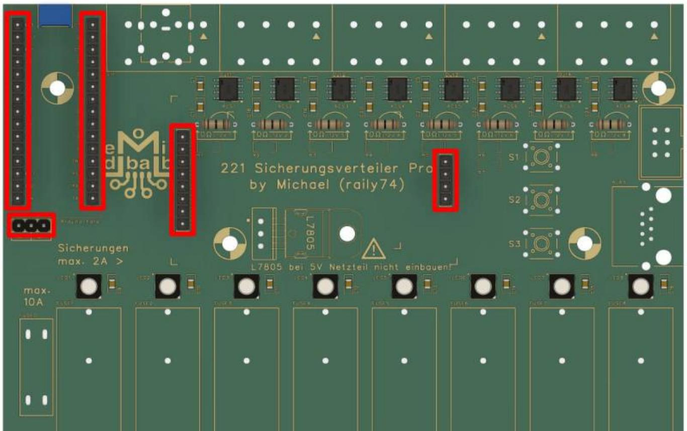
Die acht Sicherungshalter für die Feinsicherungen müssen noch vor der KFZ-Sicherung eingelötet werden, wenn man die Löthilfe verwenden möchte.
