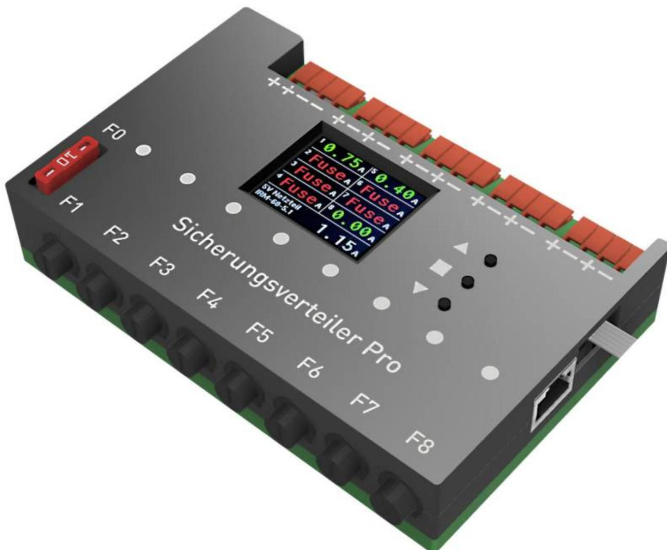
Der Sicherungsverteiler Pro vereint zahlreiche Funktionen in einem Gerät. Seine Hauptaufgabe ist das Absichern einzelner Stromkreise bei Nutzung eines gemeinsamen Netzteils mit bis zu 10A. So können bis zu acht Universalverteiler direkt an die einzeln abgesicherten Ausgänge angeschlossen werden.
