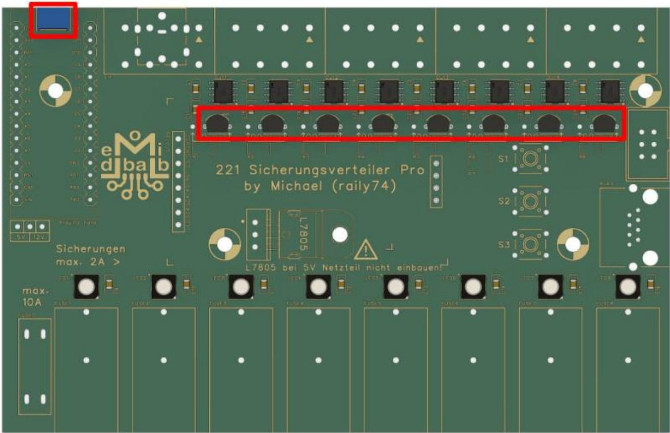
Es folgt der große Spannungsregler L7805, der den Arduino und die WS2812 LEDs mit Strom versorgt.
