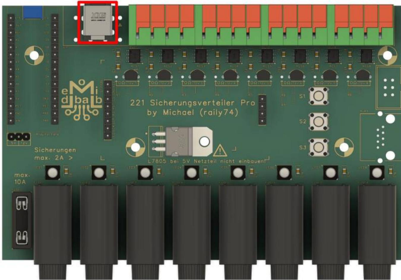
Für den Fall der Nutzung eines externen Displays und externer LEDs, werden noch eine RJ45-Buchse sowie ein Wannenstecker benötigt.
