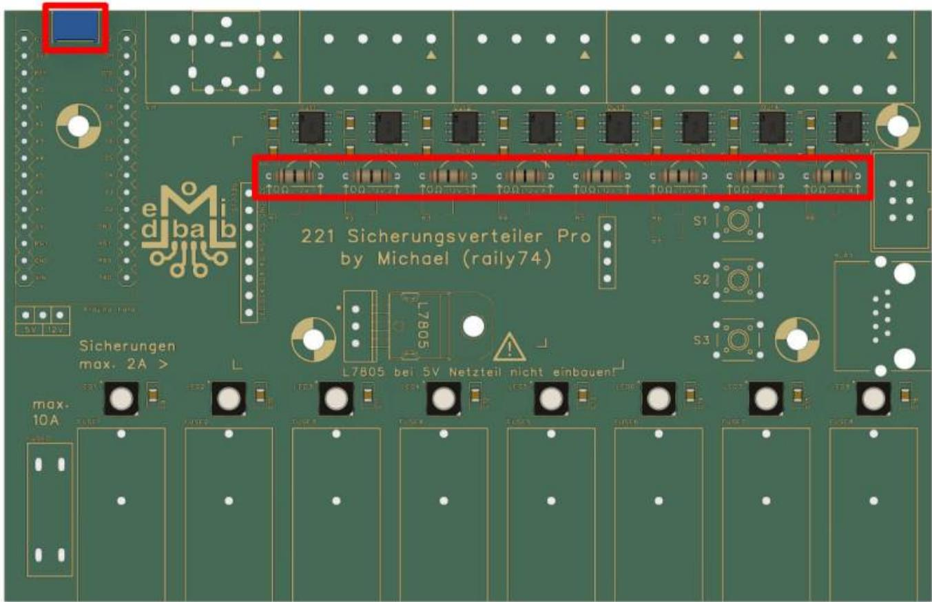
Die beiden Buchsenleisten für den Arduino, die zwei für das Display sowie die dreipolige Stifteleiste für den 5 V Jumper folgen.
