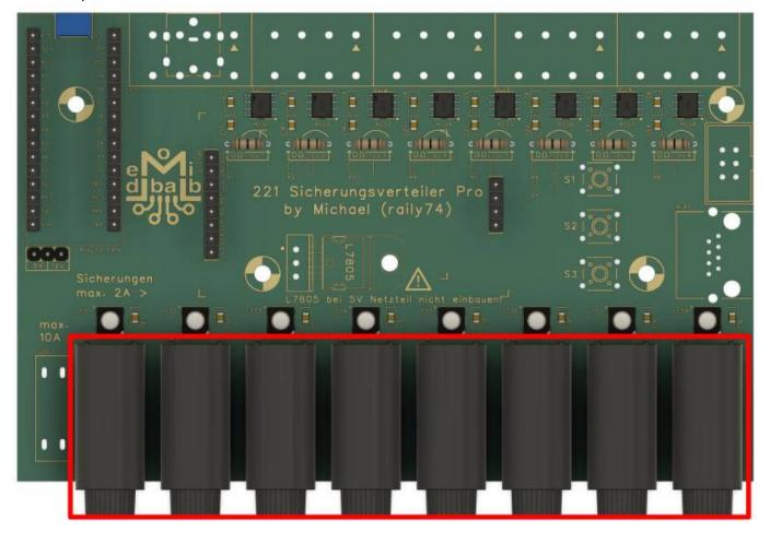
Der Halter für die KFZ-Sicherung kann im Anschluss mit eingesteckter Sicherung erfolgen.
