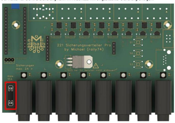
Die fünf 4-fach Klemmleisten müssen exakt ausgerichtet und gut angepresst werden. Jeden der fünf Blöcke zunächst mit einem Lötpunkt fixieren und Lage kontrollieren.
