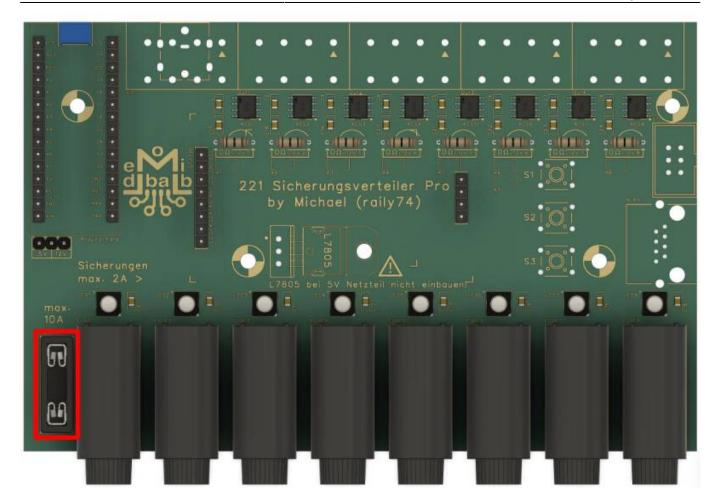
Die fünf 4-fach Klemmleisten müssen exakt ausgerichtet und gut angepresst werden. Es kann passieren, dass die Klemmleisten nicht korrekt nebeneinander passen! (Herstellertoleranz)
