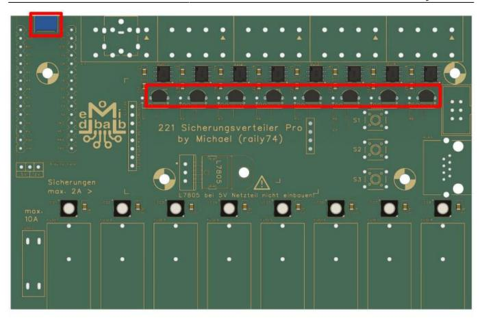
Es folgt der große Spannungsregler L7805, der den Arduino und die WS2812 LEDs mit Strom versorgt.
