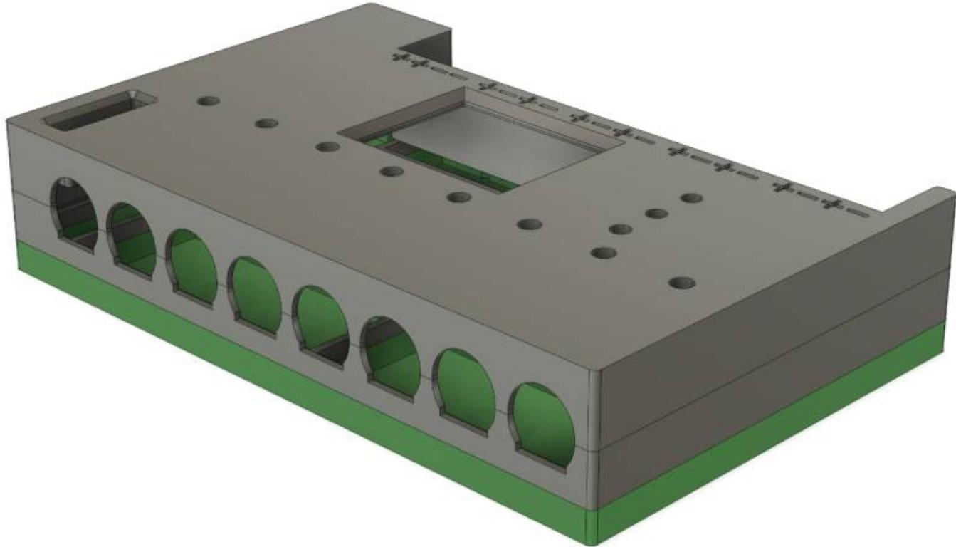
Im Github liegt eine einfache Druckdatei bereit, die auf einem einfarbigen Drucker hergestellt werden kann. Beide Teile sind so konstruiert, dass sie ohne Support mit 0,2mm Layer und 0,4mm Düse gedruckt werden können.
