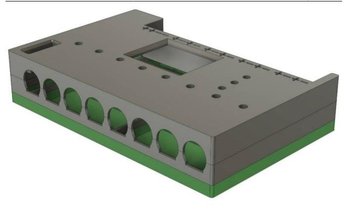
Im Github liegt eine einfache Druckdatei bereit, die auf einem einfarbigen Drucker hergestellt werden kann. Beide Teile sind so konstruiert, dass sie ohne Support mit 0,2mm Layer und 0,4mm Düse gedruckt werden können.
