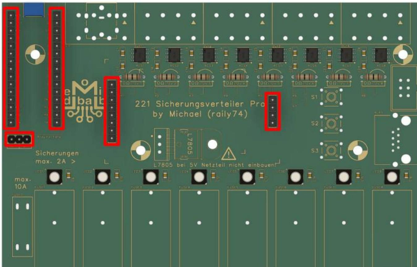
Die acht Sicherungshalter für die Feinsicherungen müssen noch vor der KFZ-Sicherung eingelötet werden, wenn man die Löthalfe verwenden möchte.
