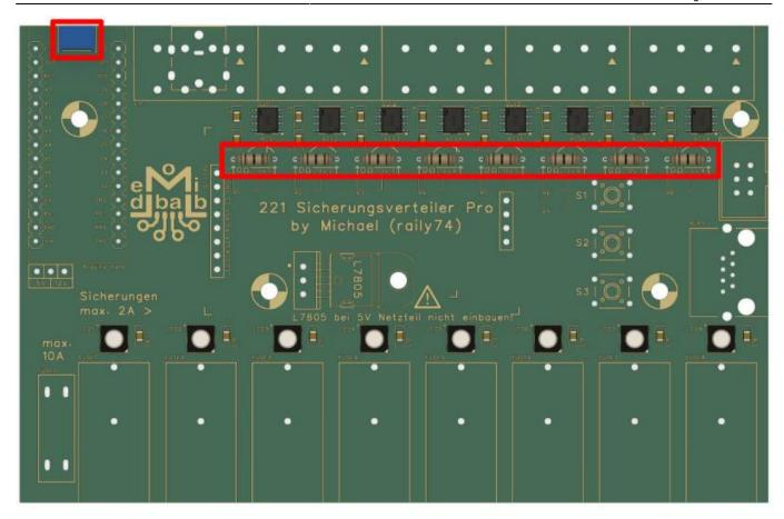
Die beiden Buchsenleisten für den Arduino, die zwei für das Display sowie die dreipolige Stiftleiste für den 5 V Jumper folgen.
