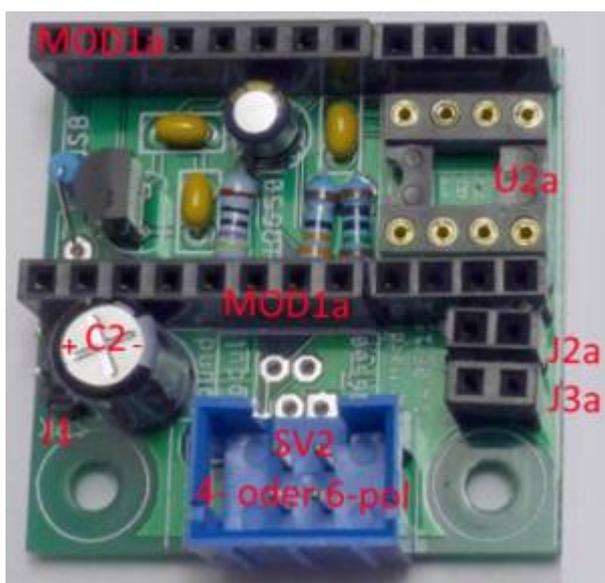
Und hier sieht man die kleinen (13 x 9 mm) Module mit Stecker: Das „Neue“ Modul hat dummerweise eine andere Anschlussbelegung. Darum muss es mit den Bauteilen nach unten eingebaut werden und zusätzlich müssen zwei Anschlüsse auf der LED Seite (oben) gekreuzt werden. Aber das ist nicht
