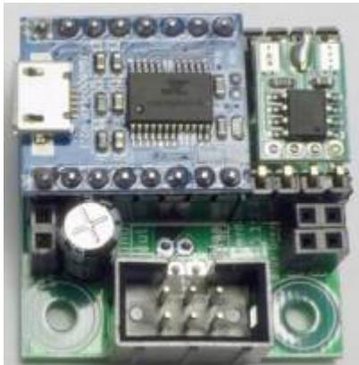
Hier mit abgezogenem Sound- und WS2811-Modul: Hier sieht man, dass man die Platine auch optional mit einem WS2811 DIL8 IC (U2) bestücken kann. Dann spart man sich das Anlöten der Winkelstecker an die WS2811 Module! Das ist zwar eine etwas teurere Option, die sich aber für nicht so lötsichere Bastler anbietet.
