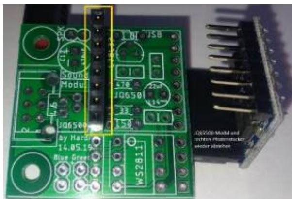
Darauf den Wannenstecker einlöten. Den LS-Stecker und den Kondensator einpassen und verlöten.
