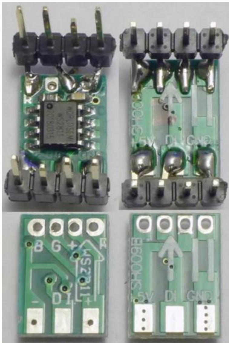
Zum löten dieser Teile habe ich mir so eine Vorrichtung gebaut, damit gelingt das anschließen der Stecker ganz gut. Die Pins welche an die Oberseite der Platine gelötet werden müssen etwas herausgezogen werden, während die anderen etwas tiefer in den Kunststoffhalter geschoben werden. Man sieht auch auf den Bildern, dass einige der Anschlüsse gebogen werden.
