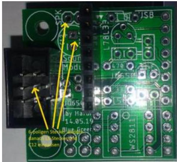
Zuerst die Teile innerhalb verlöten, Zum Schluss die obere Buchsenleiste - nur mit gestecktem JQ6500-Modul - verlöten.
