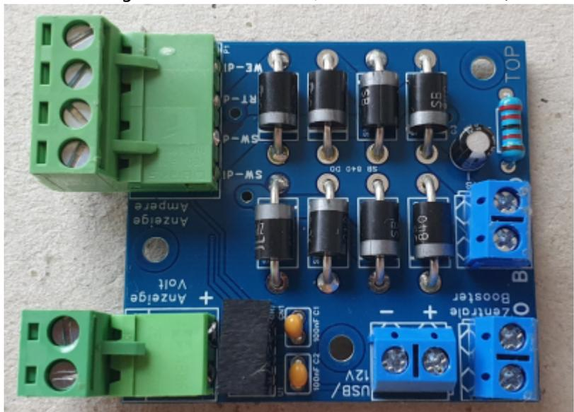
Bild der fertig bestückten Platine, mit Dioden 10A10 (hier noch Version 2.0)
