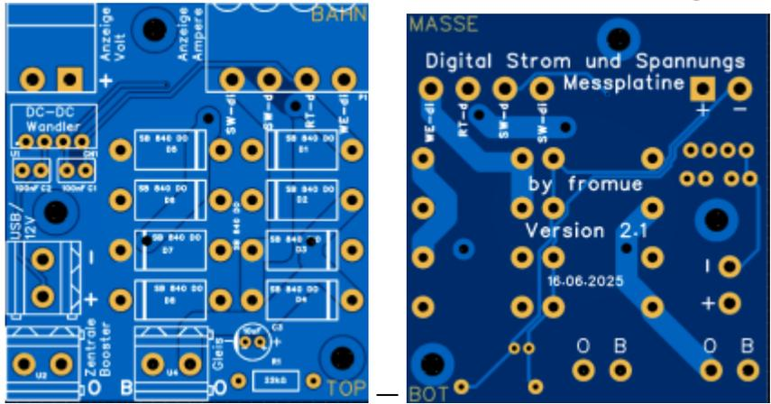
Bild der fertig bestückten Platine, mit Dioden SB840 (hier noch Version 2.0)
