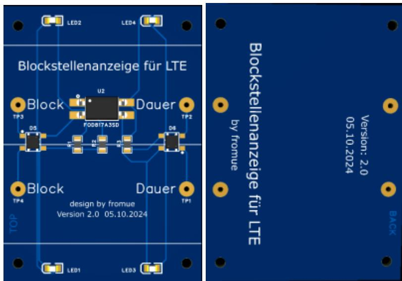
Diese Platine haben wir komplett mit Bauteilen bestückt fertigen lassen. Es müssen nur noch die Kabel an die Pads und Gleise gelötet werden. Die Platine wird diesmal direkt unter die Gleise mit Uhu-Booster UV-Kleber geklebt. Natürlich könnte man einen Gleichrichter auch wieder in Dioden auflösen und unter das Gleis klippsen, aber diesmal haben wir eine dauerhafte Lösung gesucht. Die fertigen Gleise werden komplett zusammengebaut aufbewahrt.
