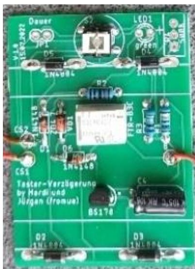
Die Linien auf der Platine an den Gleichrichterdioden sind die äußeren Gleisenden, während die inneren Linien die Böschung vom C-Gleis innen ist. Somit konnten wir genau festlegen wo die Bauteile liegen müssen, um sie unter das Gleis zu bekommen.
