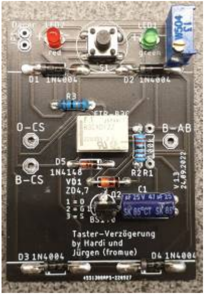
hier die fertig bestückte Platine, allerdings noch Version 1.3, ohne den 2. Kondensator
