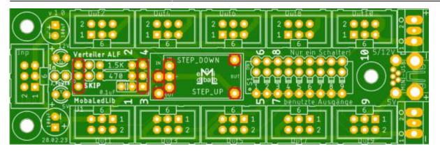
Elektrolytkondensator C1 und C8 ( $100\mu F$ , "-" ist auf der Platine und dem Bauteil markiert) 11x Wannenstecker INP, O1 - O10
