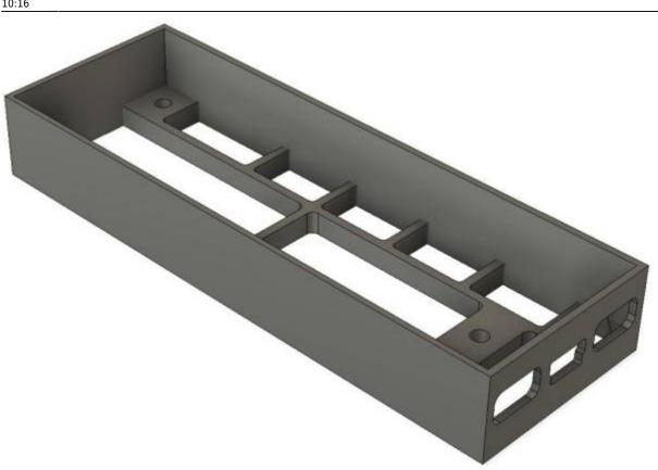
Version 3 - Für den Einsatz auf der Werkbank mit Bodenplatte und kleineren Bohrungen:
