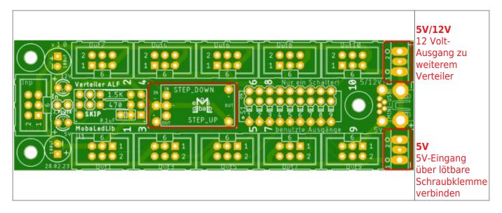
Platinenunterseite Status Lötbrücken: Keine Jumper verbinden, wenn dieser eine 12 Volt Verteiler eine Insel-Lösung darstellt!
