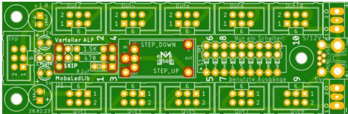
Elektrolytkondensator C1 und C8 (100µF, „-“ ist auf der Platine und dem Bauteil markiert)
