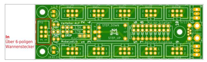
Platinenunterseite Status Lötbrücken: J1 = verbunden, J\_POWER = verbunden.
