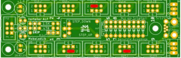
2. Einen der Jumper S1 bis S9 setzen, abhängig davon, wie viele Buchsen in Folge belegt sind. Wenn der Jumper wie auf dem unteren Bild auf S6 steckt, dann können die Buchsen 7 bis 10 nicht benutzt werden (S6 bedeutet, dass 6 Ausgänge benutzt werden).
