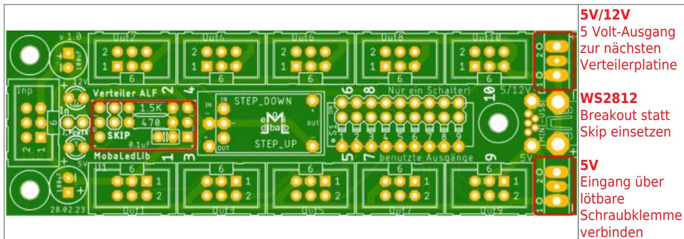
Platinenunterseite Status Lötbrücken: J1 = verbunden, J\_POWER = trennen.
