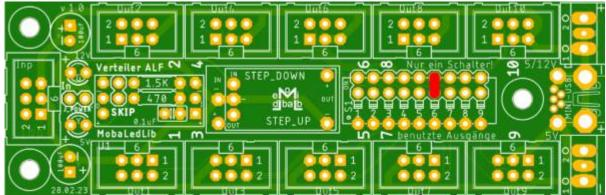
3. Einen der Schalter des DIP-Switches setzen, abhängig davon, wie viele Buchsen in Folge belegt sind.
