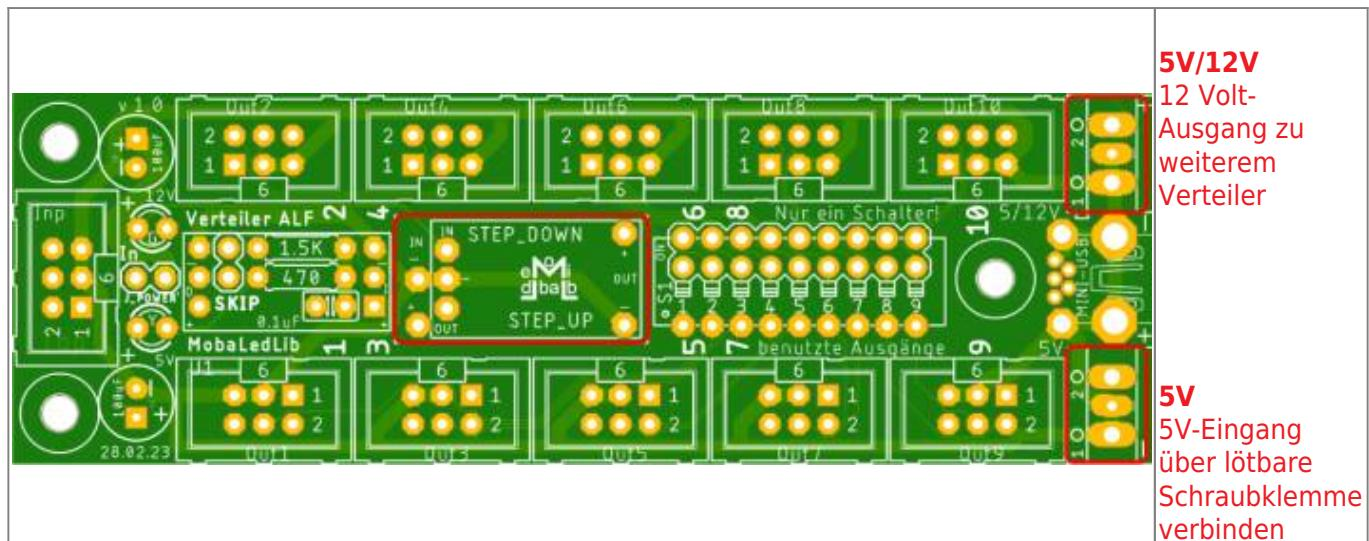
Platinenunterseite Status Lötbrücken: Keine Jumper verbinden, wenn dieser eine 12 Volt Verteiler eine Insel-Lösung darstellt!
