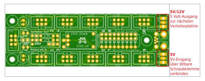
Platinenunterseite Status Lötbrücken: J1 = verbunden, J POWER = verbunden.
