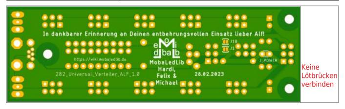
Platinenunterseite Status Lötbrücken: Jumper "J1B" verbinden, wenn alle Verteiler (200 & 282) mit 12 Volt versorgt werden
