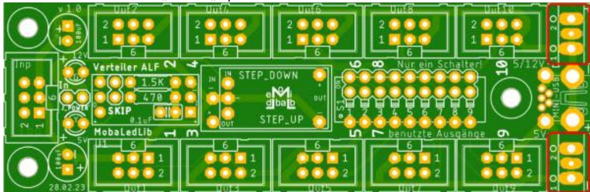
**i** Wer den Universal Verteiler dauerhaft mit dem Step Up- oder dem Step Down-Wandler betreiben möchte, sollte auf die Buchsenleisten verzichten und den Wandler über Stiftleisten direkt verlöten. Er sitzt dadurch einige Millimeter tiefer und kommt der Bedienung des DIP Schalters nicht in die Quere.
