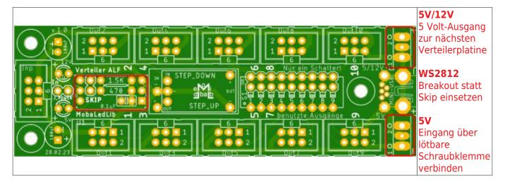
Platinenunterseite Status Lötbrücken: J1 = verbunden, J\_POWER = trennen.
