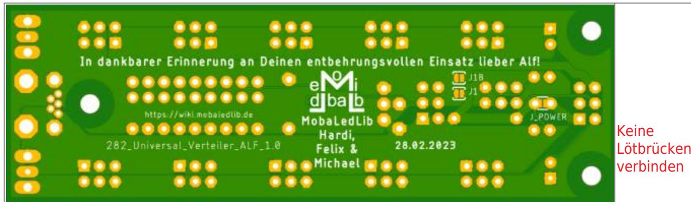
Platinenunterseite Status Lötbrücken: Jumper „J1B“ verbinden, wenn alle Verteiler (200 & 282) mit 12 Volt versorgt werden
