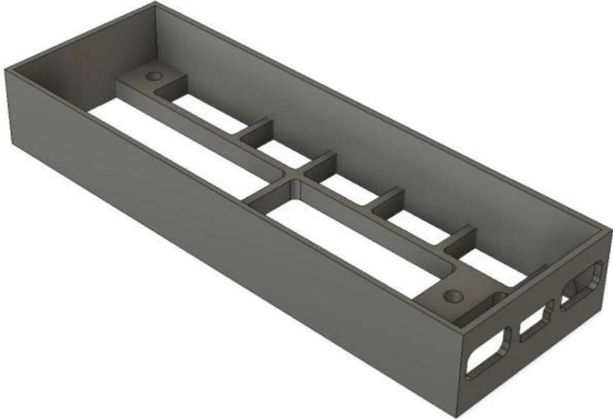
Version 3 - Für den Einsatz auf der Werkbank mit Bodenplatte und kleineren Bohrungen:
