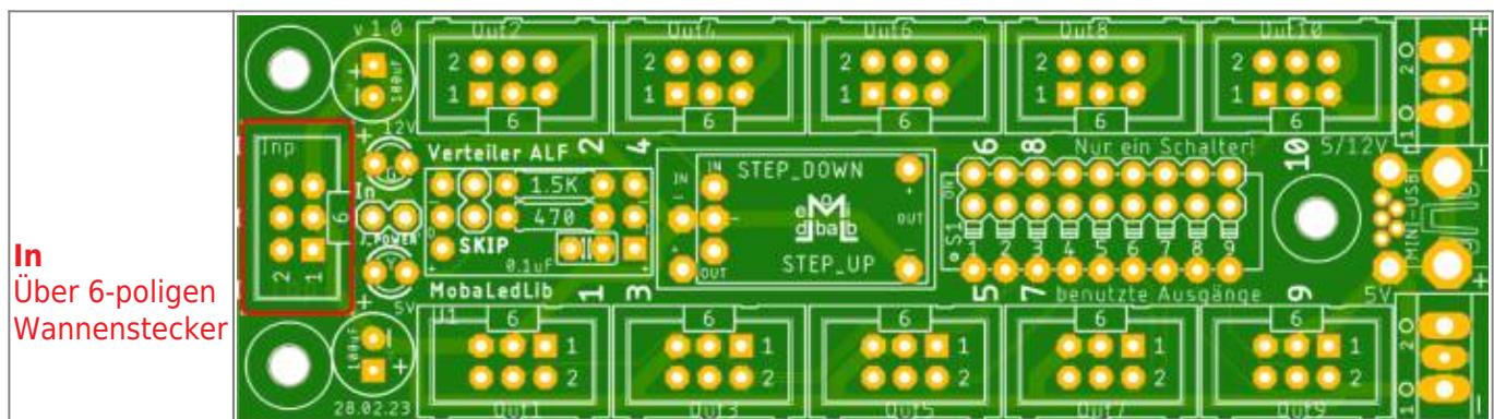
Platinenunterseite Status Lötbrücken: J1 = verbunden, J\_POWER = verbunden.
