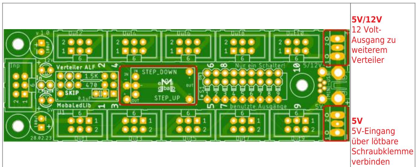
Platinenunterseite Status Lötbrücken: Keine Jumper verbinden, wenn dieser eine 12 Volt Verteiler eine Insel-Lösung darstellt!
