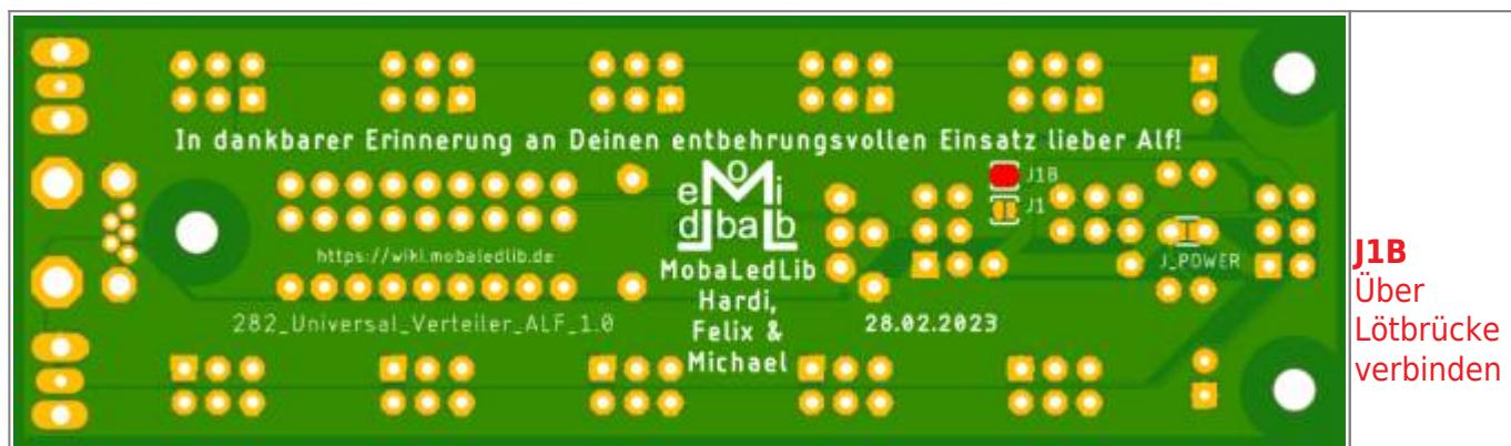
**ACHTUNG:** Mit 12 Volt ist am WS2811 die maximale Spannung erreicht. Das verwendete Netzteil muss also stabilisiert sein bzw. ist ein Step Down Wandler oder ein Festspannungsregler zwischenzuschalten! Andernfalls werden die WS2811 kurzfristig zu Rauchgeneratoren.
