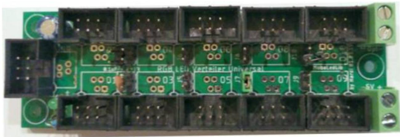
Mit der Verteiler-Platine ist es möglich, das Signal an bis zu zehn Objekte weiterzuleiten. Meist kommt das Signal dabei von der vorherigen Verteiler-Platine.
