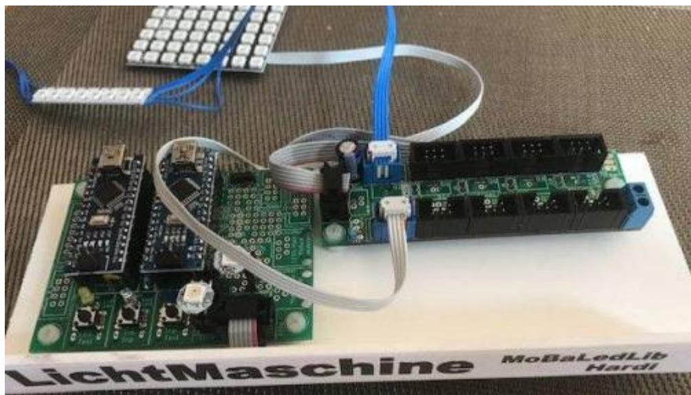
Für die LEDs welche mit der MobaLedLib angesteuert werden sollen benötigen wir 5V. Eine RGB LED verbraucht nur maximal 60mA. Mit der Bibliothek können aber bis zu 256 RGB LEDs angesteuert werden. In Summe können diese etwas über 15A verbrauchen!
