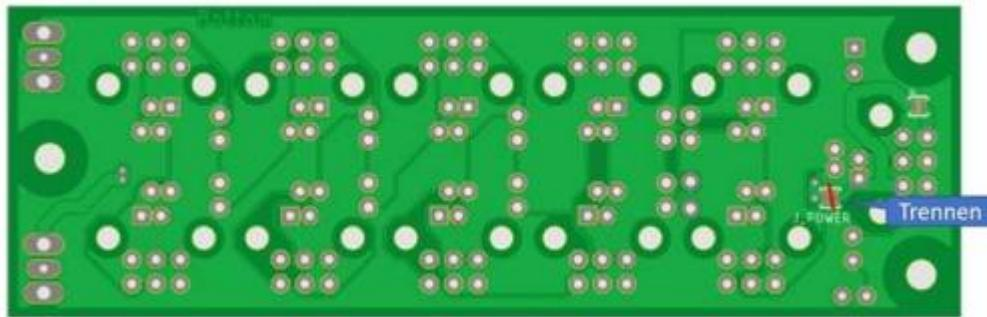
Zum Anschluss eines Netzteils sind auf der Verteilerplatine Schraubklemmen vorgesehen. Die untere Klemme ist für die 5V Einspeisung gedacht.
