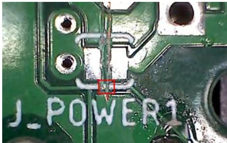
Sollte dies doch mal passieren, kann man sich mit einem kleinen Stück Decoderlitze behelfen. Dazu die beiden markierten Lötstellen mit der Decoderlitze (reicht vollkommen aus) verbinden.
