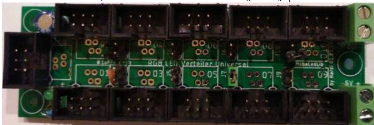
Elektrolytkondensator C8 (100µF, „-“ ist auf der Platine und dem Bauteil markiert) 11x Wannenstecker INP, O1 - O10 und 2x Schraubklemme „5V“ & „Opt IN“
