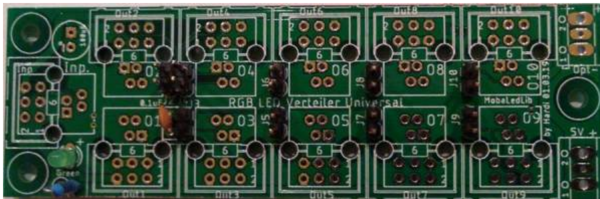
Elektrolytkondensator C8 (100µF, „-“ ist auf der Platine und dem Bauteil markiert) 11x Wannenstecker INP, O1 - O10 und 2x Schraubklemme „5V“ & „Opt IN“
