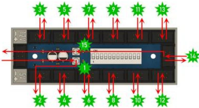
Zum einfacheren Verständnis zeigt die nachfolgende Skizze die Reihenfolge, in der die einzelnen WS281x im Programm Generator definiert werden müssen (zum Vergrößern klicken):
