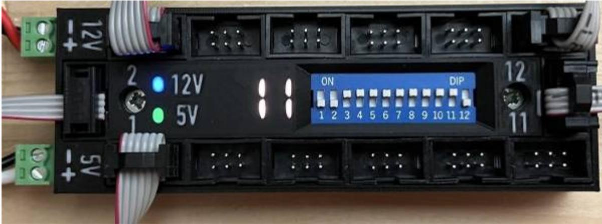
Auch wenn es technisch möglich ist, den Strom von einer Verteiler-Platine zur nächsten durchzuschleifen, so raten wir dringend davon ab. Diese Option ist die „Quick and Dirty-Variante“ für die Werkbank. Unter der Anlage raten wir dringend zu einer separaten Einspeisung der Potentiale 5V und 12V, um eine Überbelastung der Flachbandkabel zu vermeiden, da diese nur bis 1A Strom zugelassen sind.
