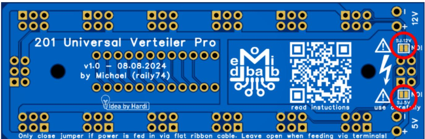
Die Lötjumper SJ.5V und SJ.12V stellen über das Flachbandkabel eine Verbindung zur vorhergehenden Platine her (Hauptplatine ESP32 oder Verteiler Platine).
