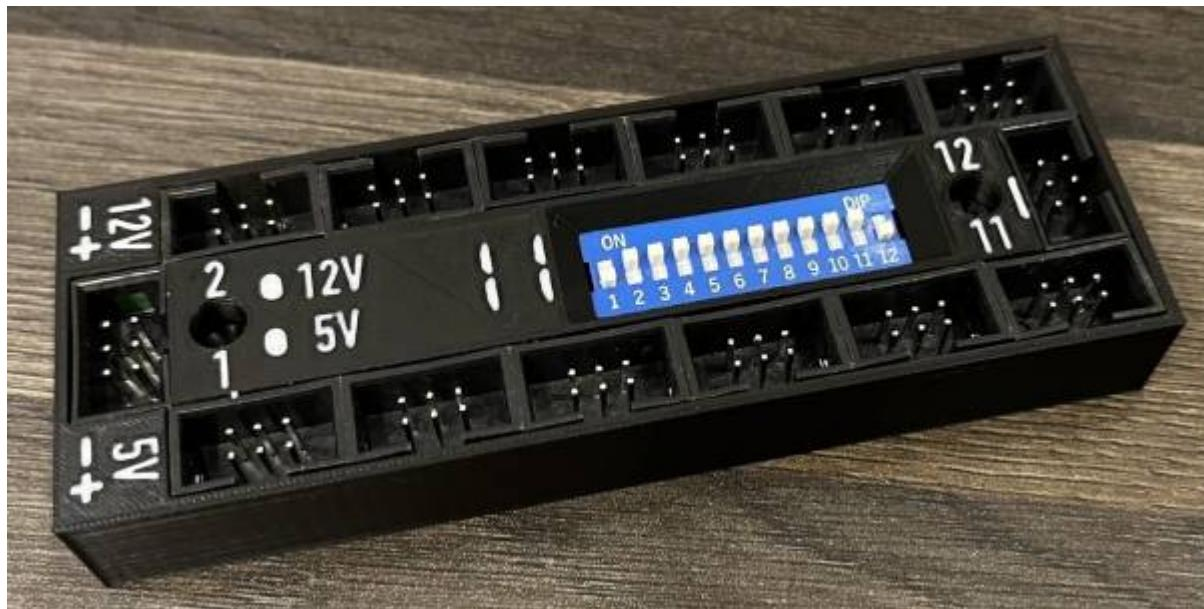
Schließt man ein Objekt bspw. an Ausgang 1 an, muss man nur den DIP-Switch 1 nach unten schieben, für Ausgang 12 den Schalter 12 usw.
