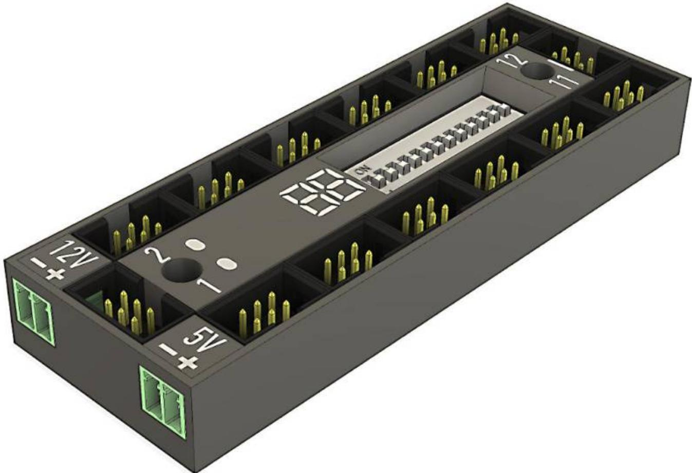
Beide Gehäuseteile sind zum Druck auf einem Drucker mit Farbwechsel-Option konzipiert. Die LEDs leuchten durch einige der weißen Flächen hindurch.
