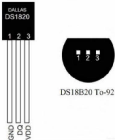
VDD bei diesem Sensor ist 3,3V - Versorgung über Kabel 8
