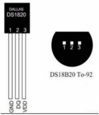
VDD bei diesem Sensor ist 3,3V – Versorgung über Kabel 8 DQ ist über Kabel 7 anzusprechen GND des Sensors ist an GND auf der Matix angeschlossen
