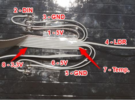
Dieses Kabelschema wurde so gewählt, damit es keine Kreuzungen gibt die innerhalb des Gehäuses unnötig auftragen und das spätere Verschließen erschweren würden.
