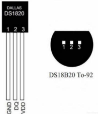
VDD bei diesem Sensor ist 3,3V - Versorgung über Kabel 8
