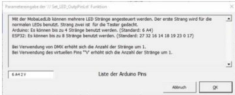
Das gezeigte Beispiel zeigt die Definition für den Arduino Nano. Hier wurden der LED-Kanal 0 (6), der PushButtonKanal 1 (A4), der LED-Kanal 2 (2) und der virtuelle Kanal V extra definiert. Bei den Zahlen in den Klammern handelt es sich um die Anschluss-Pins am Arduino.
