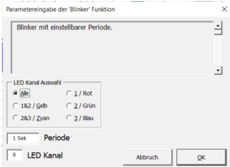
In diesem Fenster kann die Periode des Blinkers eingestellt werden. Zusätzlich kann man wählen, welche LED Kanäle verwendet werden sollen.
