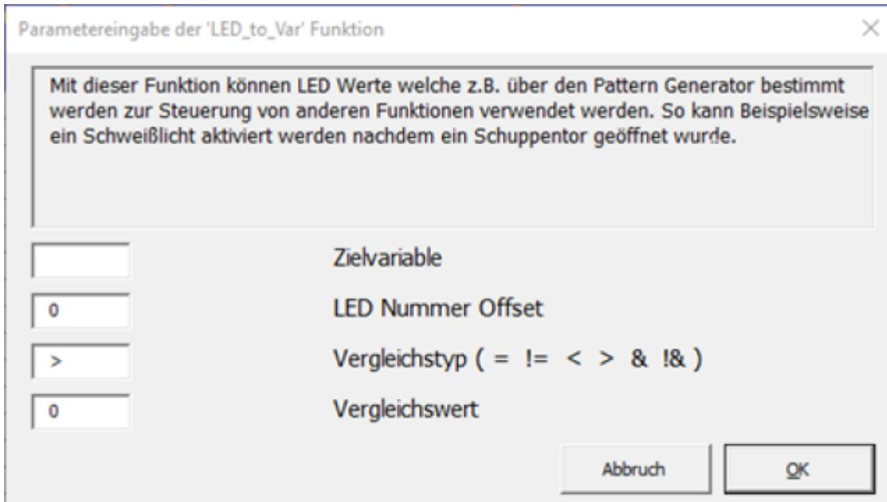
Mit dieser Funktion kann die Helligkeit anderer LEDs abgefragt und somit als Schalter genutzt werden. Das macht es beispielsweise möglich, mithilfe des Pattern Configurators einen Ablauf vorzugeben. Besonders interessant ist in dem Zusammenhang die Nutzung eines **virtuellen LED Kanals**, um nicht unnötig blinde WS2811 als Referenz zu nutzen.
