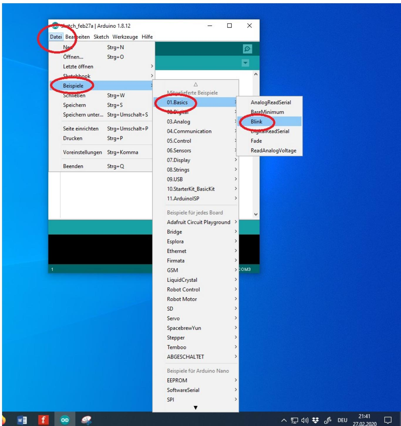
Funktioniert alles ohne Fehlermeldung, sollte die auf dem Board verbaute LED mit 0,5 Hz blinken. Bei einem neuen Arduino blinkt die LED bereits ab Werk. Durch ändern der „delay“ Werte im Sketch und erneutes Hochladen können die Blinkfrequenz und das Taktverhältnis geändert werden. So kann sicher gestellt werden, dass tatsächlich das eben hochgeladene Sketch die LED blinken lässt. Einfach mal ausprobieren.
