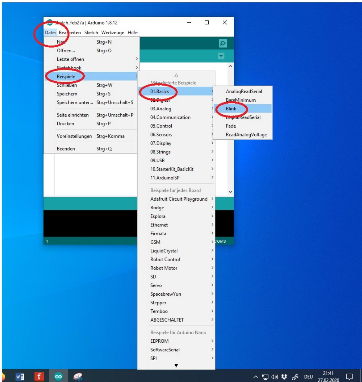
Funktioniert alles ohne Fehlermeldung, sollte die auf dem Board verbaute LED mit 0,5 Hz blinken. Bei einem neuen Arduino blinkt die LED bereits ab Werk. Durch ändern der „delay“ Werte im Sketch und erneutes Hochladen können die Blinkfrequenz und das Taktverhältnis geändert werden. So kann sicher gestellt werden, dass tatsächlich das eben hochgeladene Sketch die LED blitzen lässt. Einfach mal ausprobieren.
