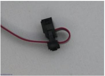
4. Den zweiten Deckel aufsetzen und mit der Hand zusammendrücken. Diesmal gibt es zwei etwas lautere Klicks, wenn die Zugentlastung sauber eingerastet ist.
