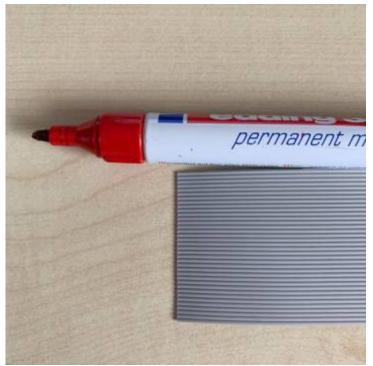
2. Permanent-Stift in die Vertiefung zwischen zwei Kabel setzen und entlangziehen
