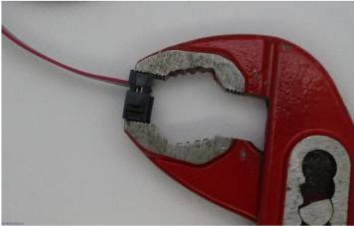
3. Nun kann man das Kabel in einem kleinen Bogen über den Stecker legen und die Zugentlastung anbringen. Dabei das Kabel nicht zu fest anziehen, um es nicht zu beschädigen.
