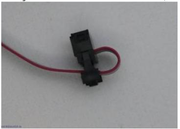
4. Den zweiten Deckel aufsetzen und mit der Hand zusammendrücken. Diesmal gibt es zwei etwas lautere Klicks, wenn die Zugentlastung sauber eingerastet ist.
