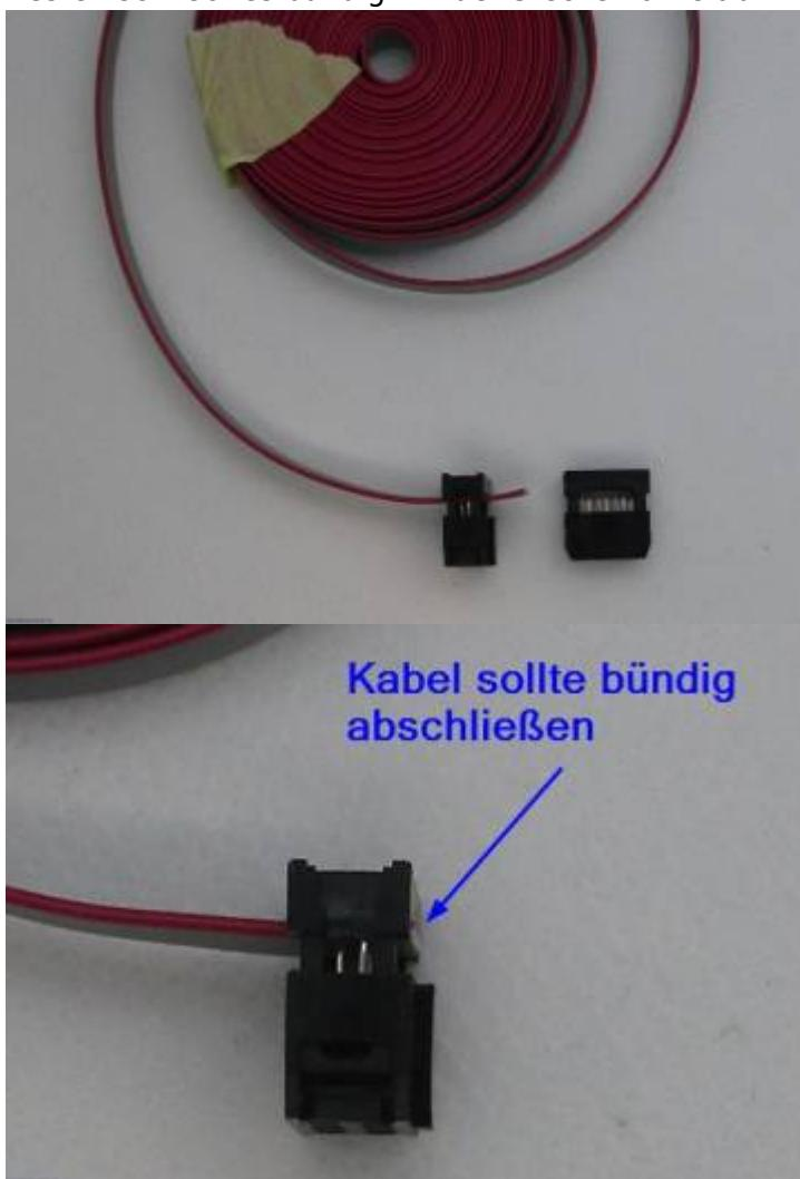
2. Nun wird der Stecker in die Zange eingelegt und mit sanfter Kraft die Zange und somit der Stecker zusammen gedrückt. Sobald man zwei sehr leise Klicks hört, ist der Deckel eingerastet.
