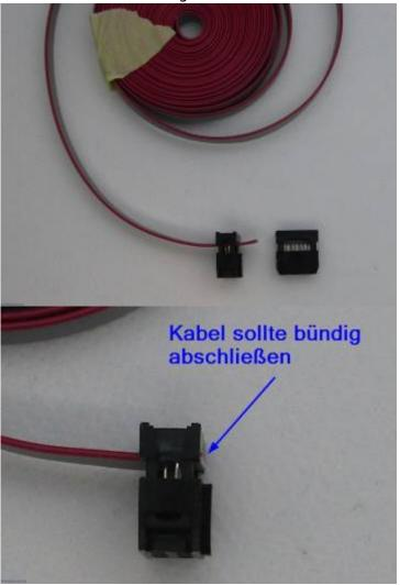
2. Nun wird der Stecker in die Zange eingelegt und mit sanfter Kraft die Zange und somit der
