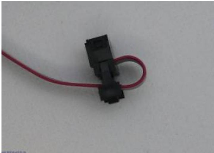
4. Den zweiten Deckel aufsetzen und mit der Hand zusammendrücken.
