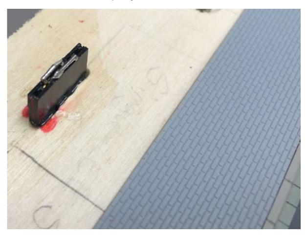
Die Isolierung erfolgt im Anschluss mit einem 3D-Druck Gehäuse mit Griff (ein bisschen Heißkleber tut's aber auch).
