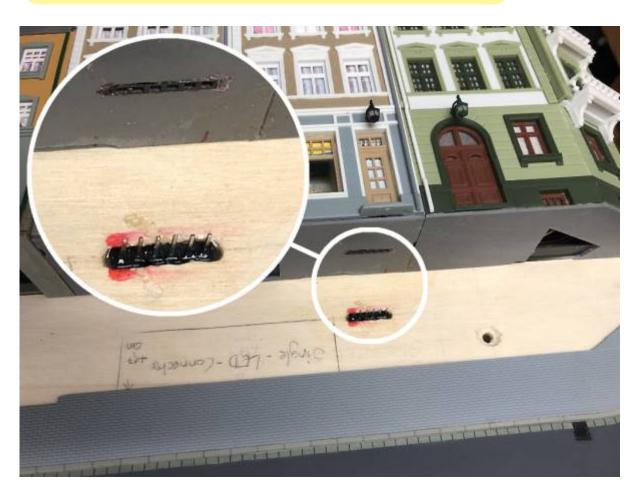
Die Grundidee basiert auf Hausanschlüssen, die durch exakte Positionierung von Stecker und Buchse in Gebäude und Holzplatte automatisch eine Verbindung herstellen, sobald das Haus an der richtigen Stelle abgestellt wird. Da die Pfostenbuchse und der Wannenstecker eine präzise Führung und mehr Kraft zum Lösen bzw. zum Verbinden benötigen, fiel die Wahl auf einfache Stift- und Buchsenleisten. Diese bieten etwas mehr Spiel.
