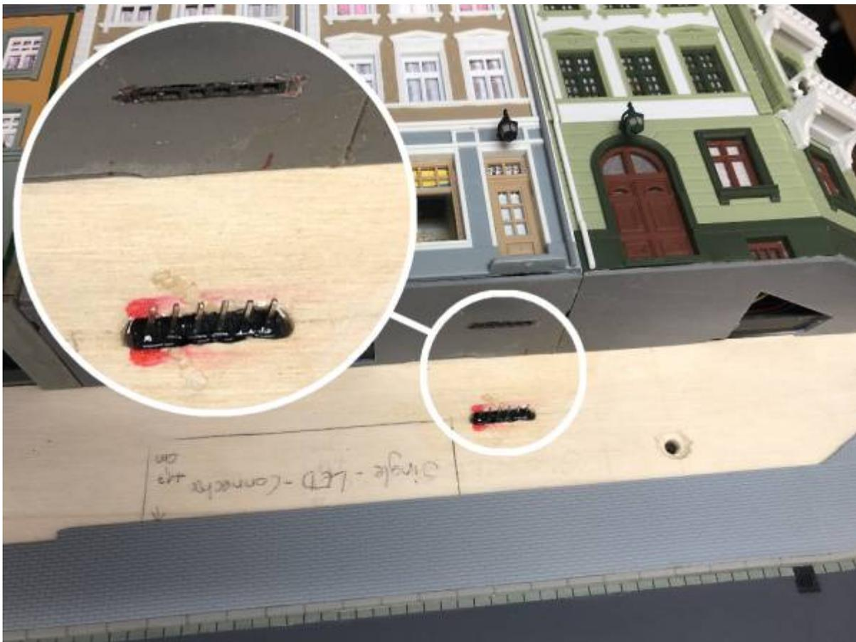
Die Grundidee basiert auf Hausanschlüssen, die durch exakte Positionierung von Stecker und Buchse in Gebäude und Holzplatte automatisch eine Verbindung herstellen, sobald das Haus an der richtigen Stelle abgestellt wird. Da die Pfostenbuchse und der Wannenstecker eine präzise Führung und mehr Kraft zum Lösen bzw. zum Verbinden benötigen, fiel die Wahl auf einfache Stift- und Buchsenleisten. Diese bieten etwas mehr Spiel.
