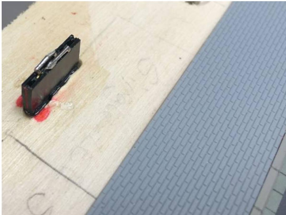
Die Isolierung erfolgt im Anschluss mit einem 3D-Druck Gehäuse mit Griff (ein bisschen Heißkleber tut's aber auch).
