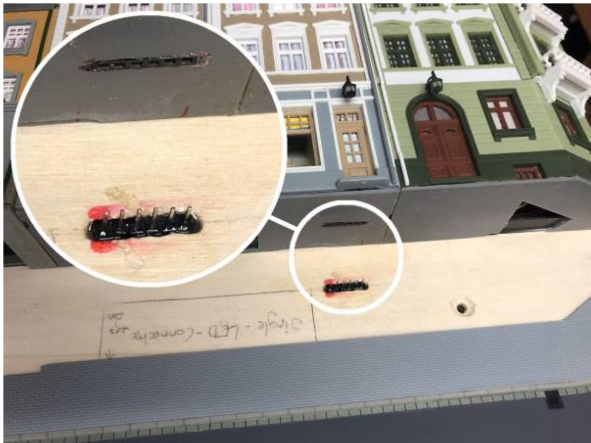
**100% verpolungssicher:** Die Brücke verbindet immer „D in“ mit „D out“ und „GND“ mit „GND“.
