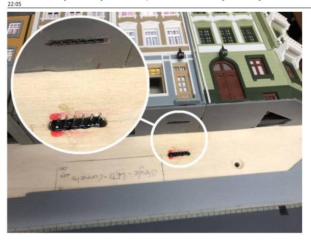
100% verpolungssicher: Die Brücke verbindet immer "D in" mit "D out" und "GND" mit "GND".
