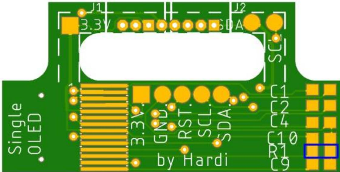
gefolgt von den Kondensatoren C9 und C10 ( $4,7\mu F$ ),
