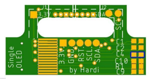
und den Kondensatoren C1 und C2 ( $1.0\mu F$ ).
