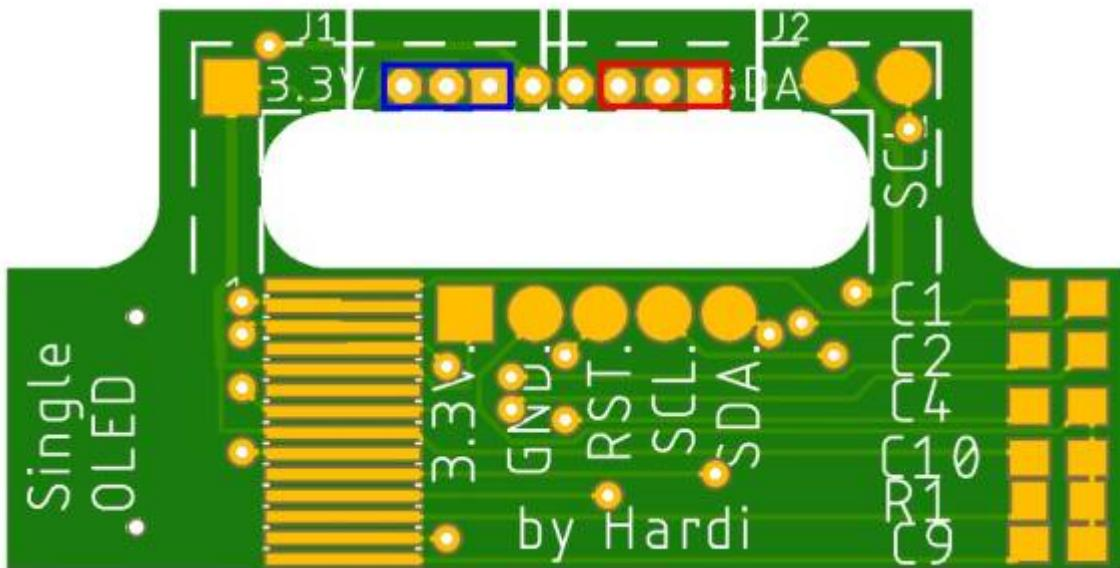
Bei der Verwendung des sechspoligen Verbinder J2&J3, kommt die Buchse in diese Lötpunkte.
