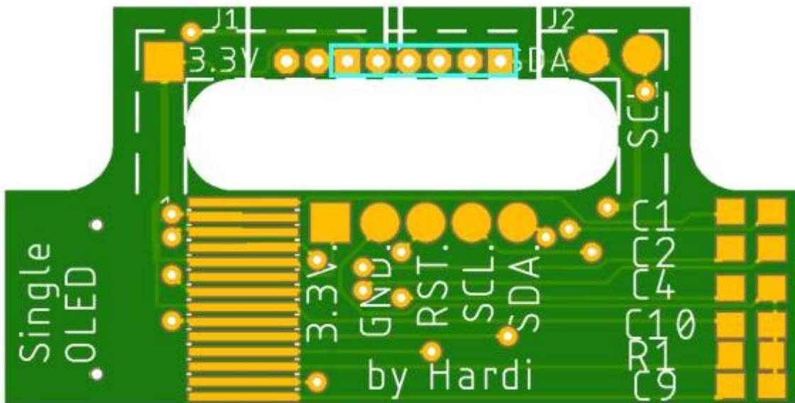
Die Belegung der Kontakt ist wie auf dem nachfolgenden Bildern beschrieben. SDA2 wird dabei für die Platine mit 1x Display nicht benötigt und muss nicht verbunden werden.
